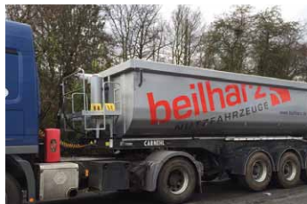
Carnehl Halbschalenmulde in HARDOX oder Aluminiumausführung
