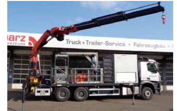
Sonderaufbau Schachtbefahrungsanlage LKW mit Palfinger Ladekran
