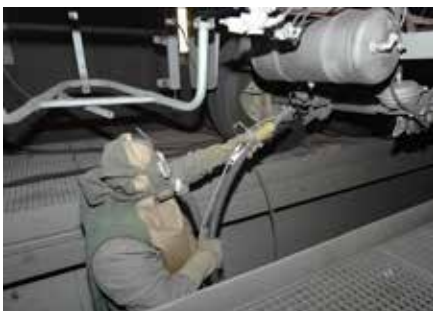
Unsere Strahlanlage zur Entrostung und Lackiervorbereitung
